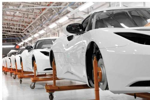
Il telaio all'avanguardia della Evora è composto da una struttura di alluminio estruso e incollato, sviluppata con un design leggero ma incredibilmente rigido, con una vasca centrale che racchiude l'abitacolo del guidatore e l'abitacolo di sicurezza, una struttura del tutto simile allo schema e alla realizzazione delle moderne auto da competizione. Il design esclusivo assicura un
